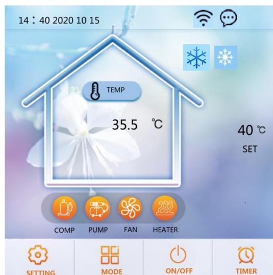
Por ejemplo, cambiar el modo de funcionamiento de calentamiento a enfriamiento
